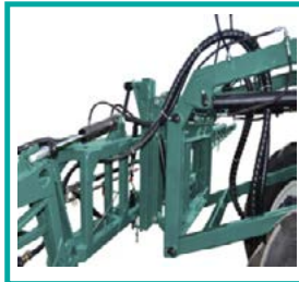
Sollevamento idraulico della barra Hydraulic lifting booms
