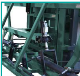
Correzione del livellamento idraulico Hydraulic levelling correction
