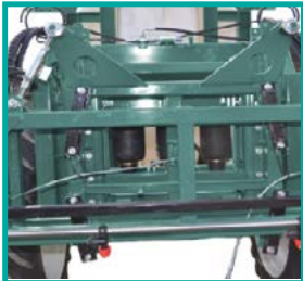
Sospensioni ad aria della barra Boom air suspension
