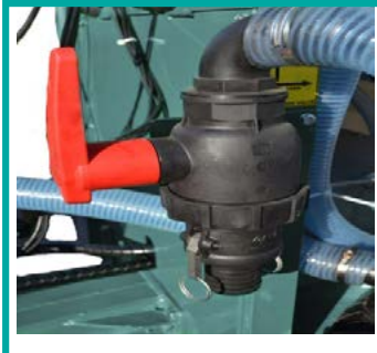
Filtro predisposto per l'autoriempimento Intake filter predisposed for self-filling
