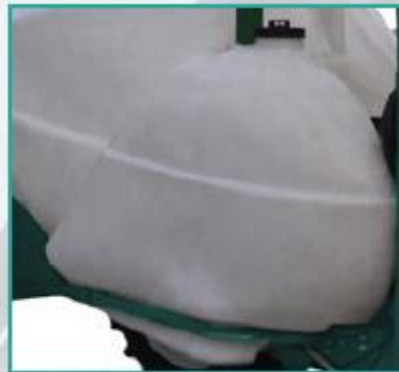
Rezervoar za pranje ruku i sistema Hand and circuit washing tank
